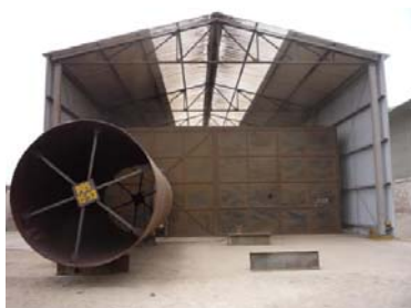
Módulo de granallado, evita la dispersión de material particulado a zonas aledañas.
